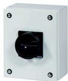
**Hauptschalter, P3, 100 A, Aufbau, 3-polig + N, HALT-Funktion, mit schwarzem Drehgriff und Sperrkranz, abschließbar in 0-Stellung, im Stahlgehäuse**
