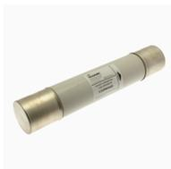
**Motor-Sicherungseinsatz, Mittelspannung, 70 A, AC 5.5 kV, 60 kA, 76 x 403 mm, Pufferung, US, Mit Schlagmelder, 2R**
